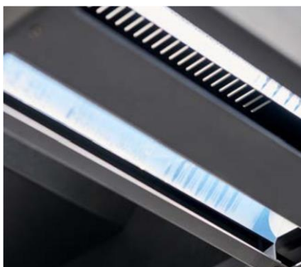
LED-es világítórendszer a tükröződés- és árnyékmentes eredményért
